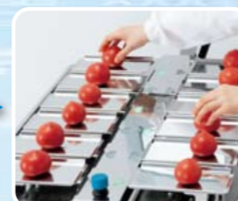
③瞬時に計量し、最良の組み合わせのLEDランプが緑色に点灯します。
