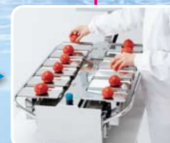
④LEDランプが点灯している計量皿からトマトを取ります。
